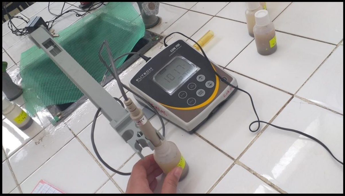
صورة 4 : عملية قياس الناقلية الكهربائية
